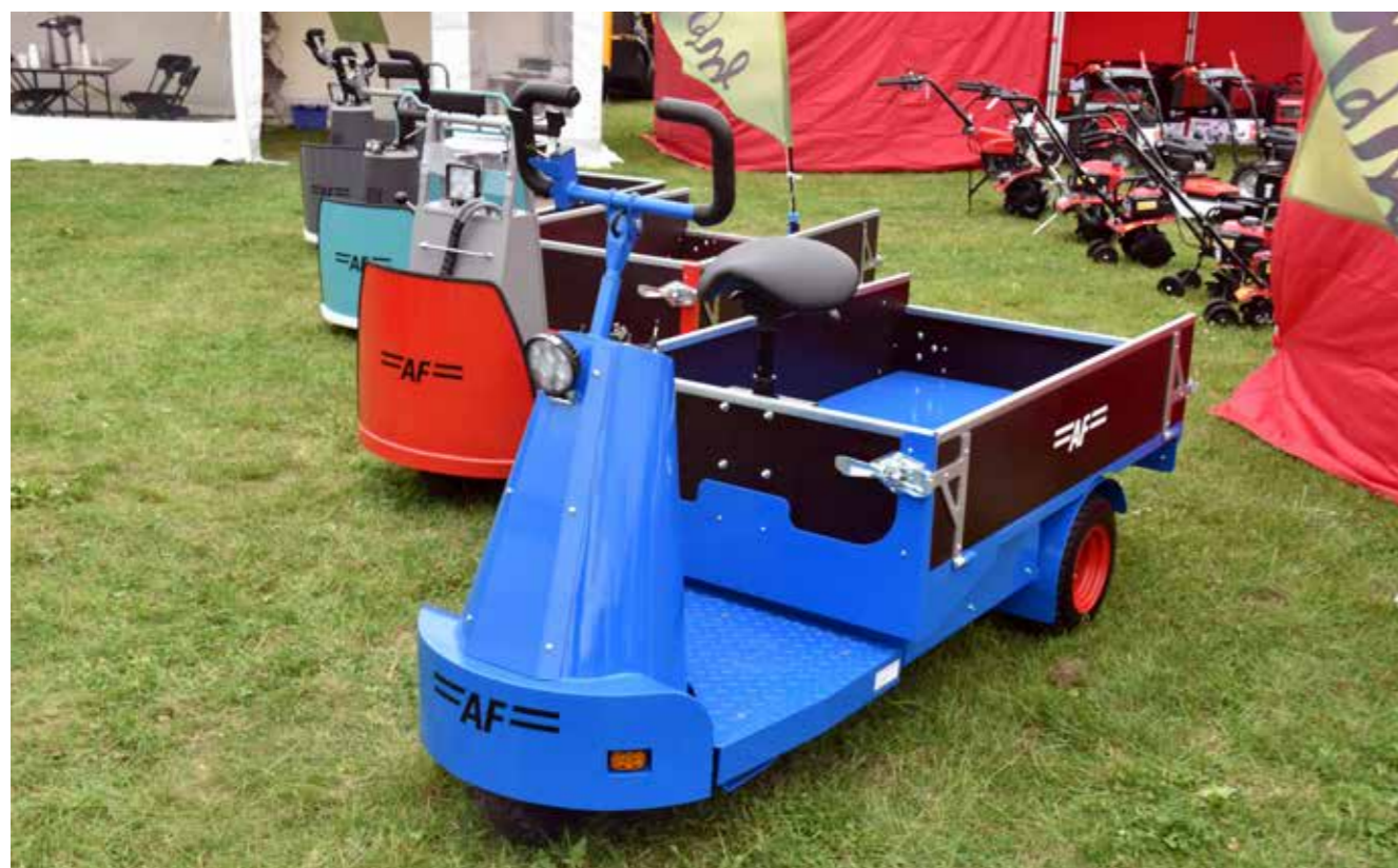
A. Flensborg viste en prototype af afløserne til deres model PM-PARK. Der er sket to markante ændringer, nemlig at den er baghjulstruktet i stedet for forhjulstruktet. Det skal sikre et bedre træk, når den er læsset til.
