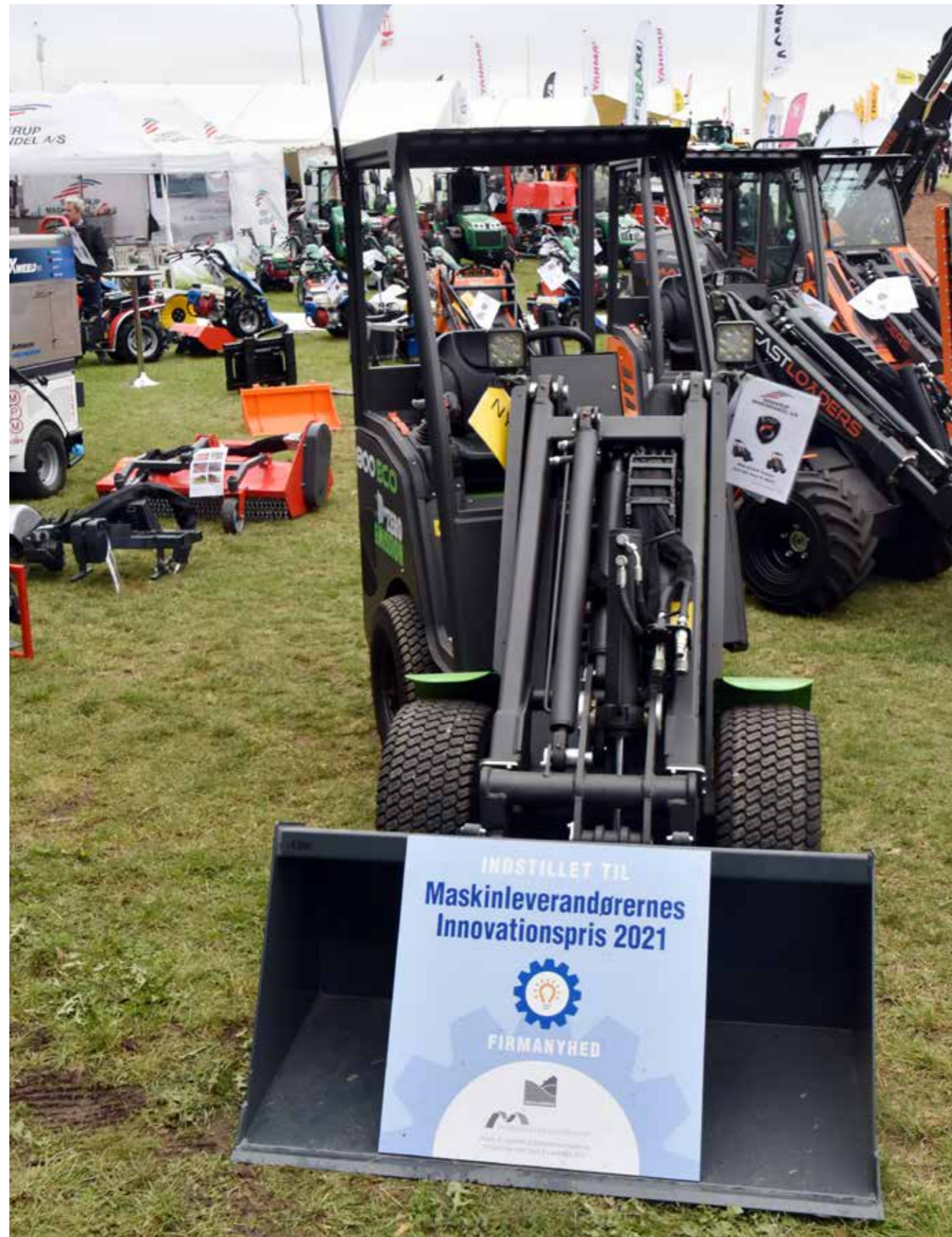
Sønderup Maskinhandel A/S viste Castloader der er drevet af el. Ifølge sælgeren er den konstrueret så den ikke kan vælte. Den har en udvendig bredde på 1250 mm.
