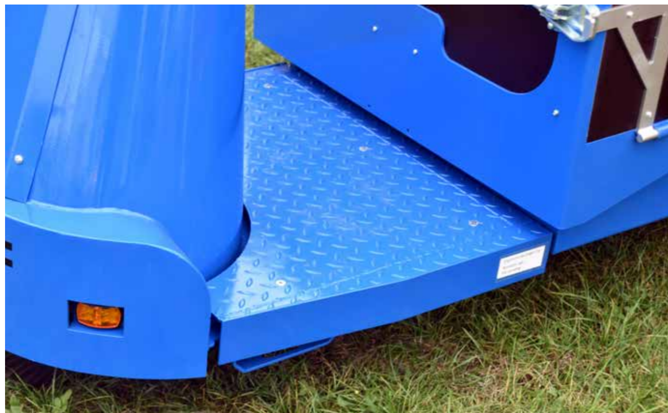
Den anden store ændring er, at der i samarbejde med en ergoterapeut er udviklet en ny platform der kan absorbere ujævnhederne i køreunderlaget.
