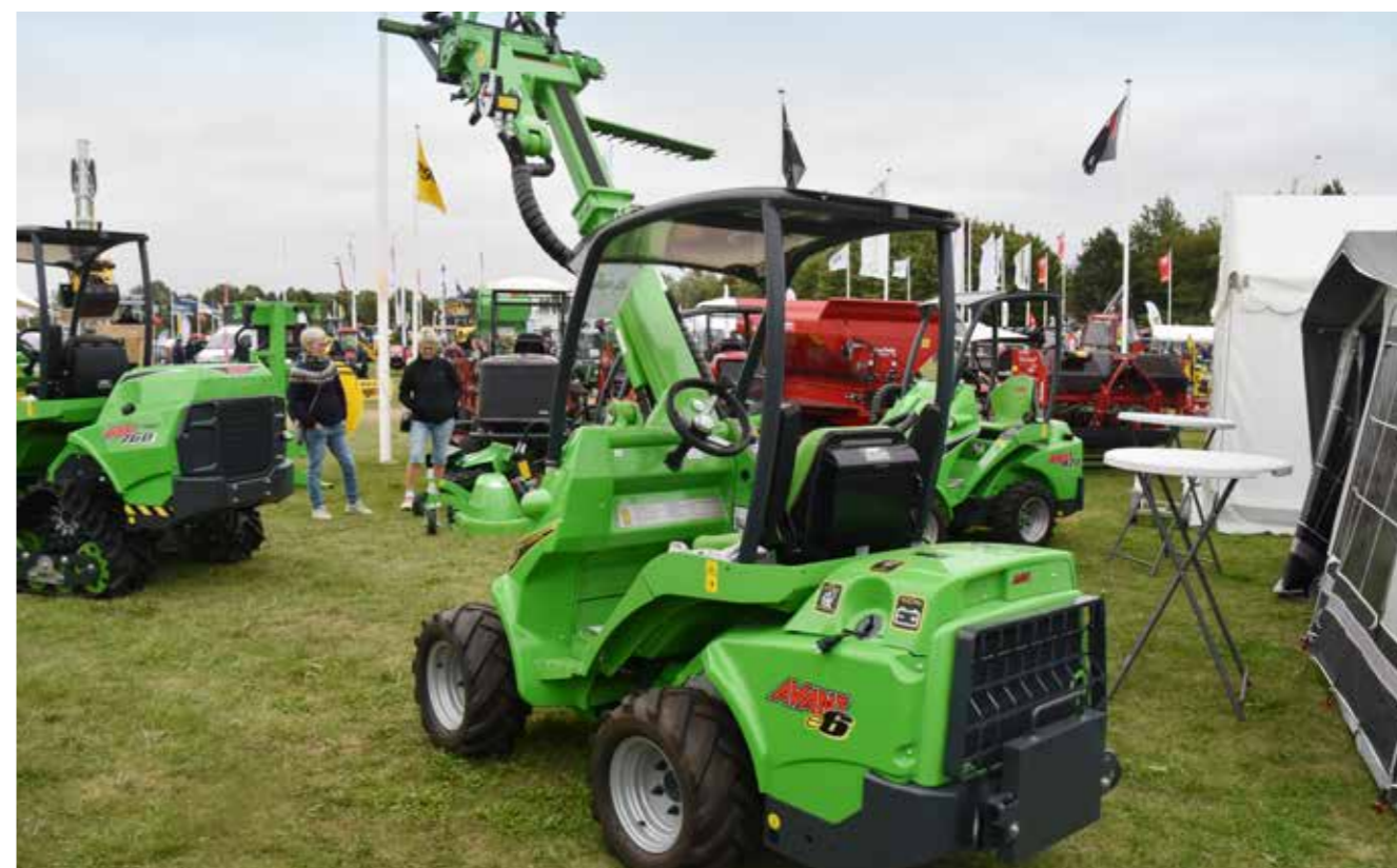
Avant E6 minilæsser. Det er den mindste eldrevne minnilæsser fra deres produktprogram. På grund af størrelsen på batteripakkerne forventer de ikke der kommer mindre modeller på markedet i El drift. Sporvidden er fra 1030 til 1420 mm., afhængig af dækmønteringen.
